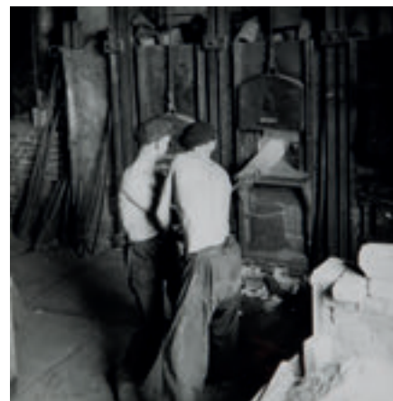
Bereits im 19. Jahrhundert wurden die lohmannschen Schmiedehämmer mittels Wasserkraft betrieben. Auf dem Foto: Arbeiter am Schmiedehammerofen
