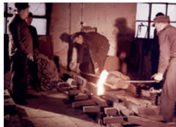
Johann Friedrich Lohmann und sein Sohn waren 1812 die Ersten, die Tiegelguss-Stahl in höchster Güte in Deutschland produzierten. Auf dem Foto: Arbeiter beim Abguss des Tiegelschmelzofens
